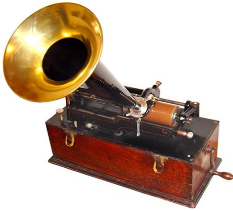
Рис 3. Фонограф Томаса Эдисона, использовавшийся для языковых и фольклорных записей.
